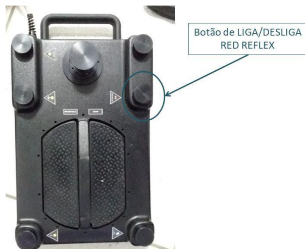
Figura 12 – Ilustração dos botão de acionamento de RED REFLEX do MC Pedal FOCUS
