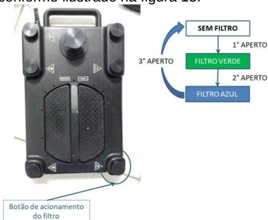
Figura 13 – Ilustração do botão de acionamento do filtro do MC Pedal FOCUS
