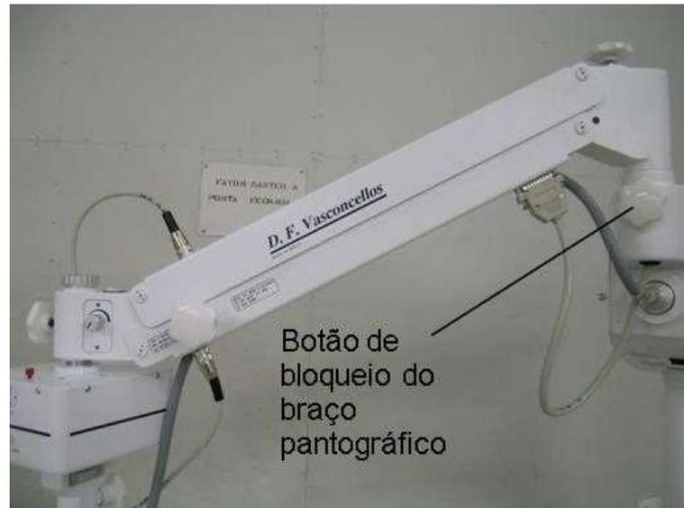
**Figura 10 - Ilustração botão de bloqueio do braço pantográfico**
