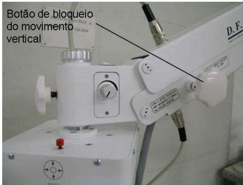
**Figura 11 - Ilustração do botão de bloqueio do movimento vertical**
