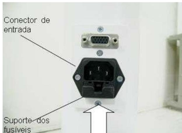
**Figura 37 – Conector com suporte para fusíveis**
