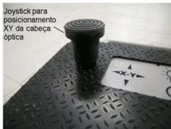
Figura 5 - Ilustração do joystick para posicionamento XY da cabeça óptica
