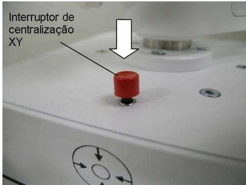
**Figura 8 - Ilustração do interruptor de centralização XY.**
