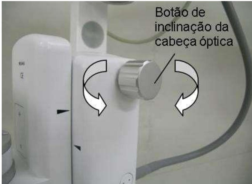
**Figura 14 - Ilustração do botão de inclinação da cabeça óptica.**
