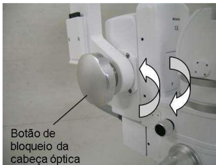
**Figura 13 - Ilustração do botão de bloqueio da cabeça óptica**
