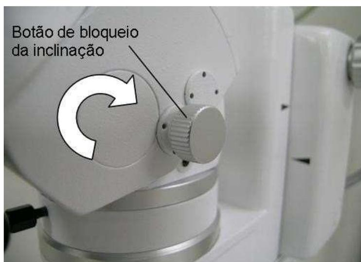
Figura 20- Botão de bloqueio da inclinação
