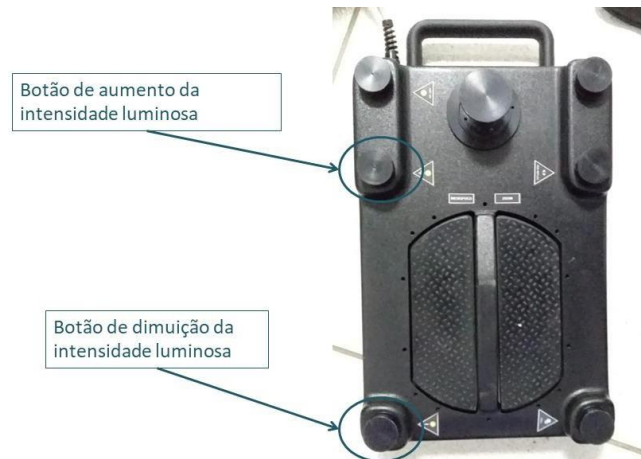
Figura 12: Ilustração dos botões de ajuste da intensidade luminosa do Pedal.
