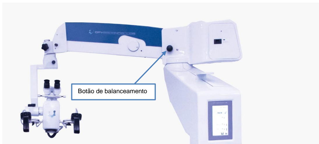
Figura 2: Ilustração do botão de balanceamento.
