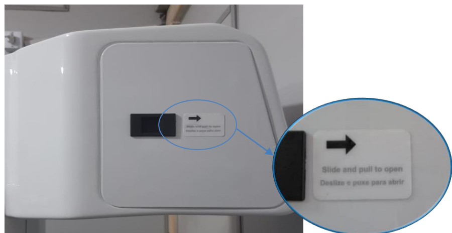
Figura 17: Proteção do conjunto de iluminação.
