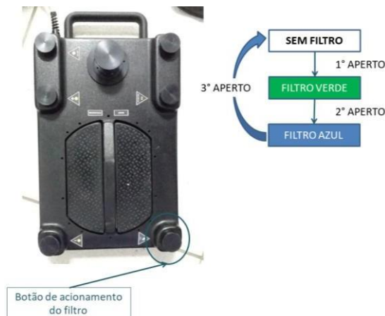
Figura 13: Ilustração do botão de acionamento do filtro Pedal.
