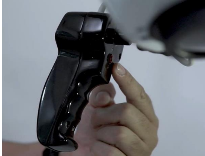
Figura 4: Parte posterior do Joystick onde está localizado o botão do freio eletromagnético.
