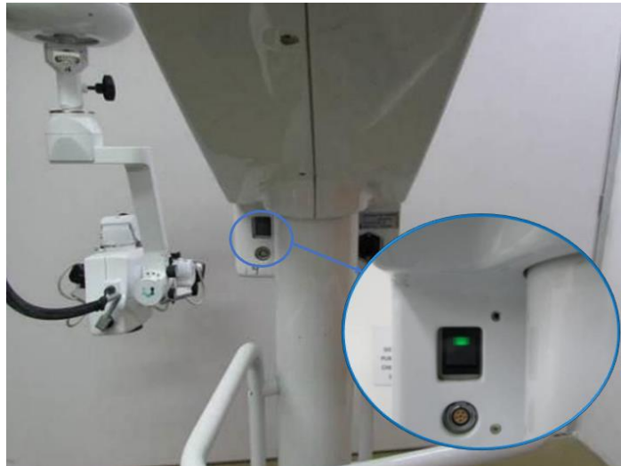
Figura 16: Botão verde para ligação do equipamento no braço fixo.
