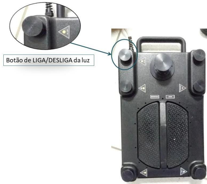
Figura 11: MC Pedal NEVRO, de acionamento da luz.
